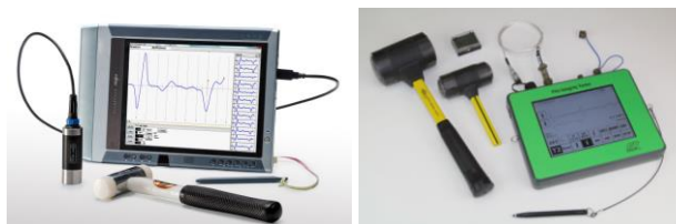
Figura 2. Equipamentos PET (esquerda) e PIT (direita). Fonte: Piletest e Pile Dynamics Inc.
